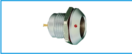
ZGG固定式插座，螺母固定，定位销（G）或定位销（A...F，L和R）
