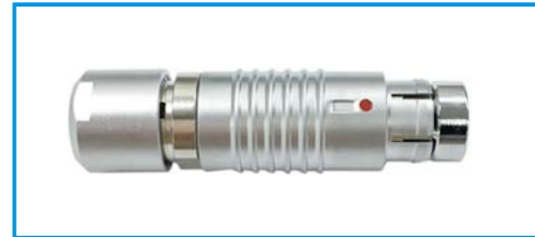
TGN 插头标准型长款直插头 ， 电缆夹固定电缆， 内部零件防止电缆转动， 半圆金属防止误插。（不带护套型）
