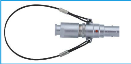
TNG 直式插头，定位销（G）或定位销（A...M和R），电缆线夹和带护套型的尾盖（和解锁拉绳）
