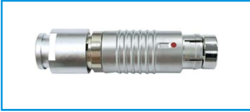
TGN 标准型长款直插头 ， 电缆夹固定电缆， 内部零件防止电缆转动， 半圆金属防止误插。（带护套型）
