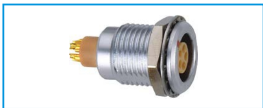
ZGG固定式插座，螺母固定，定位销（G）或定位销（A...M和R）（机箱内固定）
