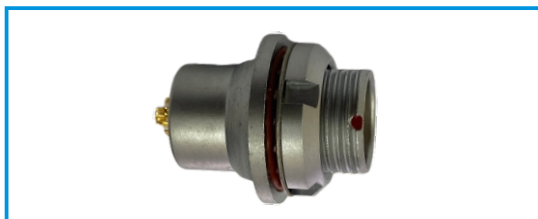
MEG 固定式插座，螺母固定，定位销（G）或定位销（A...M和R）水密封或真空密封（后面板安装）IP68
